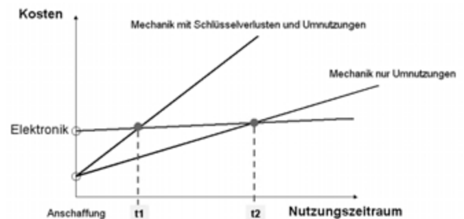
Bild 1: Kostenverlauf mechanische und elektronische Schließanlagen
